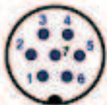
DIN 7 pins connector
